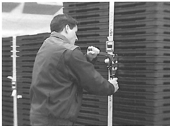
Mit EasyLash Tex Gurtbändern sind Systemfestigkeiten von bis zu 8.000 daN erreichbar.
